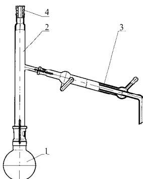
Предназначен для количественного определения спирта в настойках, рассчитываемого по температуре кипения настойки при определенном давлении.
