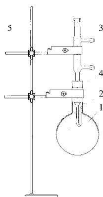
Предназначен для определения содержания эфирного масла в растительном сырье по методу Гинзберга путем перегонки его с водяным паром и последующего измерения объема полученного масла, выраженного в процентах по отношению к абсолютно сухому сырью.
