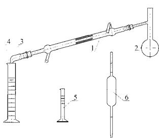
Предназначен для определения фракционного состава бензина и лигроина методом перегонки.
