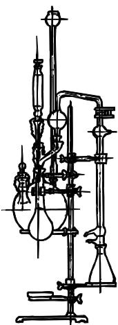
Предназначен для определения азота в органических веществах.
