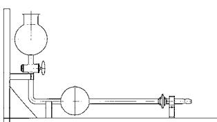
Предназначена для определения объемной доли  $\text{CO}_2$  в жидкой и газообразной двуокиси углерода в соответствии с ГОСТ 8050-85.
