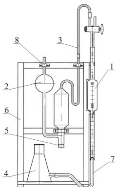
Предназначен для определения процентного содержания кислорода в техническом и медицинском кислороде и кислородосодержащих газовых смесях при контроле производственного кислорода и при технологическом контроле работы воздухоразделятельных установок.
