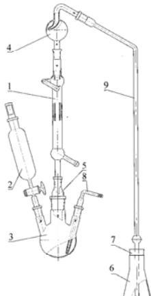
Состоит из холодильника ХПТ-1-200-14/23 поз.1, воронки ВД-2-100, поз.2, колбы КГУ-3-1-250 поз.3 со штуцером поз.8, каплеуловителя КО-14/23-60 поз.4, перехода П-1-29/32-14/23 поз.5, колбы Кн-3-100-34 поз.6, пробки резиновой поз.7, трубы соединительной поз.9
