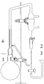
Предназначен для определения содержания эфирного масла в растительном сырье по методу Клевенджера путем перегонки его с водяным паром и последующего измерения объема полученного масла, выраженного в процентах по отношению к абсолютно сухому сырью.
