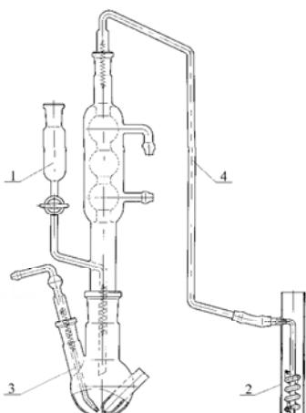
Состоит из холодильника 1, абсорбера 2, колбы со штуцером 3, трубы 4. Детали аппарата соединяются между собой с помощью шлифов конических взаимозаменяемых по ГОСТ 8682-93, закрепленных соответственно пружинками.
