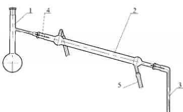
Состоит из колбы с отводом поз.1, холодильника ХПТ поз.2, алонжа поз.3, соединенных между собой с помощью шлифов конических взаимозаменяемых.
