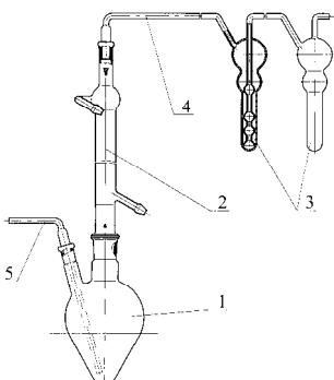
Состоит из колбы остродонной ОГ-2-500-29/32-14/23 поз.1, холодильника ХПТ-2-400-29/32-14/23 поз.2, двух поглотителей Рихтера скоростных поз.3, трубы соединительной поз.4, керна типа КИО поз.5. Детали соединяются между собой шлифами коническими взаимозаменяемыми по ГОСТ 8682-93 и трубкой резиновой медицинской поз.6.
