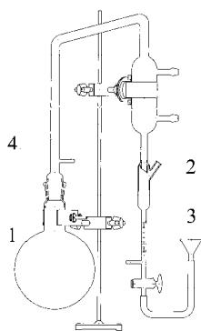
Предназначен для определения содержания эфирного масла в растительном сырье по методу Клевенджера путем перегонки его с водяным паром и последующего измерения объема полученного масла, выраженного в процентах по отношению к абсолютно сухому сырью. Методики проведения испытания и расчета по ГОСТ 24027.2-80.
