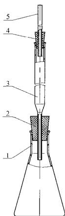
Состоит из колбы конической Кн-3-100-22 поз. 1 с пробкой резиновой поз. 2, через которую вставлена трубка поз. 3 с наконечником. Трубка закрывается пробкой поз. 4, через которую проходит стеклянная трубка диаметром 5 мм поз. 5
