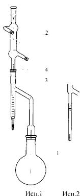
Предназначен для количественного определения содержания воды в нефтяных, пищевых и других продуктах методом отгонки. Методика проведения испытания и расчета содержания воды в нефтепродуктах по ГОСТ 2477-65.
