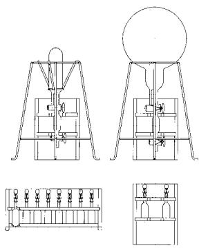
Предназначен для определения содержания кислорода в чистом азоте и аргоне колориметрическим методом. Метод основан на окислении меди (одновалентной в двухвалентную) кислородом анализируемого газа. При этом бесцветный раствор медно-аммиачного комплекса одновалентной меди окрашивается в синий цвет, характерный для медно-аммиачного комплекса двухвалентной меди. Окрашенный раствор сравнивается с эталонными растворами сульфата меди разных концентраций в водном четырехпроцентном растворе аммиака.
