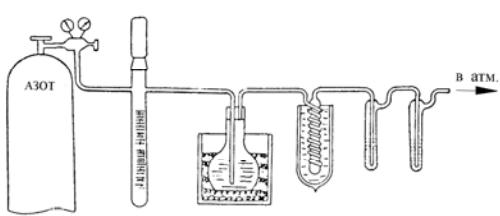
Предназначен для определения ацетилена:
