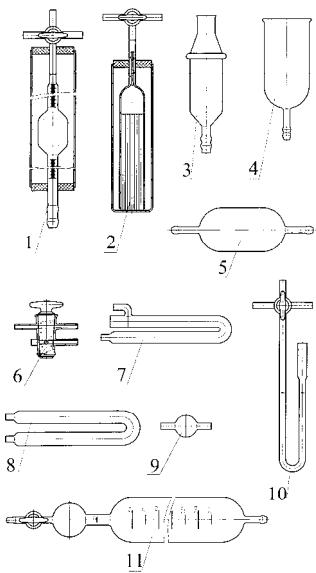
Состоит из бюретки поз.1, сосуда поглотительного поз.2, сосуда напорного для затворной жидкости поз.3, сосуда напорного для воды поз.4, сосуда поз.5, крана распределительного поз.6, трубы для ХПИ, гопкалита, силикагеля поз.7, трубы для активированного угля поз.8, трубы поз.9, манометра поз.10, бюретки вместимостью 275 мл поз.11.
