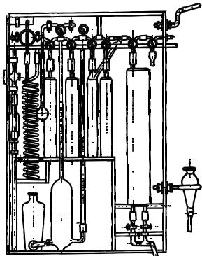
Предназначен для анализа газов, содержащих CO<sub>2</sub>, O<sub>2</sub>, N<sub>2</sub>, CO, H<sub>2</sub>, C<sub>n</sub>H<sub>m</sub>, CH<sub>4</sub>, типа коксового, природного и других газов.
