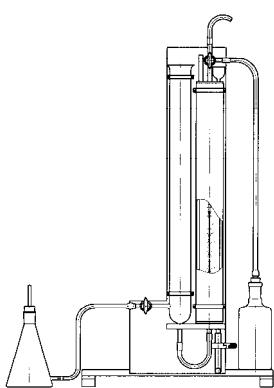
Предназначен для определения процентного содержания углекислоты, связанной с химическим поглотителем, а также для определения содержания кислорода в кислородообразующих веществах.
