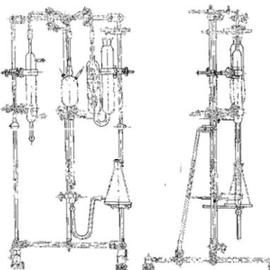
Предназначен для объемного определения газовых смесей СО и CO<sub>2</sub>, получаемых при анализе чугуна и стали методом сжигания навески по ГОСТ 12344-88 и утвержденным методикам с дальнейшим расчетом содержания углерода в %.
