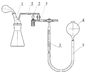
Предназначен для количественного определения содержания растворенной воды в нефтяных маслах по ГОСТ 7822-75.
