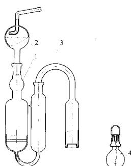
Предназначен для определения содержания серы в нефтепродуктах сжиганием в лампе по ГОСТ 19121. Допускается использование прибора для определения содержания других элементов в нефтепродуктах.
