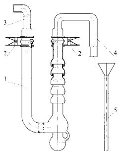
Предназначен для получения в приборах и аппаратах высокого вакуума.
