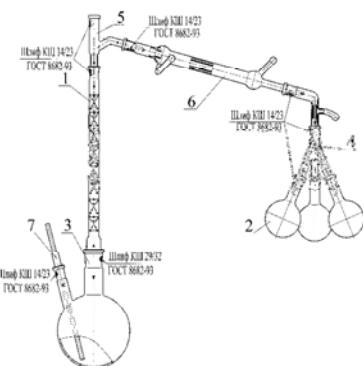
Состоит из дефлегматора поз.1, колб круглодонных поз.2, колбы двугорлой поз.3, комплекта АКП поз.4, насадки поз.5, холодильника поз.6, трубы поз.7.
