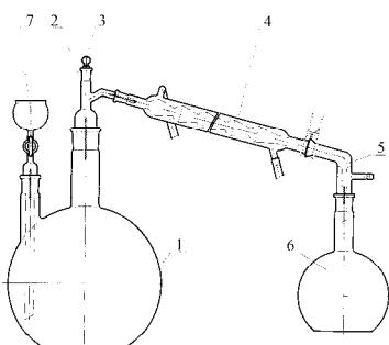
Предназначен для получения дистиллированной воды, а также отдельных фракций различных веществ путем перегонки.
