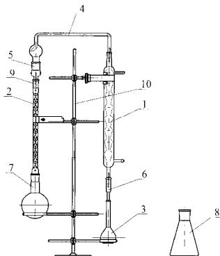
Состоит из холодильника поз.1, дефлегматора поз.2, колбы мерной поз.3, насадки поз.4, перехода поз.5, трубы поз.6, колбы конической, вместимостью 500 мл поз.7, колбы конической, вместимостью 250 мл (сменная часть) поз.8. Детали установки соединяются между собой с помощью шлифов конических взаимозаменяемых по ГОСТ 8682-93, закрепляются пружинками поз.9 и устанавливаются на штативе поз.10 с помощью держателей.
