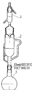
Предназначен для определения водонефтенасыщенности исследуемого грунта, а также водонасыщенности других материалов путем извлечения твердых веществ легкокипящими растворителями.
