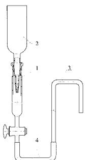
Предназначена для восстановления нитратов при определении их в продуктах переработки плодов и овощей фотометрическим методом по ГОСТ 29270-95.
