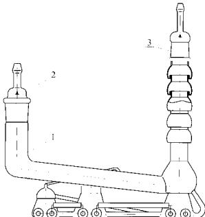
Предназначен для получения в приборах и аппаратах высокого вакуума.
