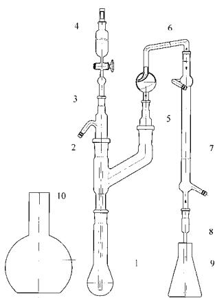
Состоит из колбы Кильдаля вместимостью 250 мл поз.1, насадки Н3-29/32 поз.2, насадки поз.3, воронки капельной вместимостью 100 мл поз.4, перехода П1-1-29/32-14/23 поз.5, каплеуловителя КО-14/23-100 поз.6, холодильника ХПТ-1-300-14/23 поз.7, трубы поз.8, колбы конической вместимостью 250 мл поз.9, колбы плоскодонной вместимостью 2000 мл. поз.10
