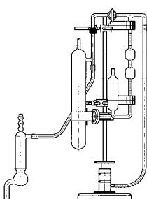
Предназначен для измерения удельной поверхности цементов и аналогичных порошкообразных материалов методом воздухопроницаемости.
