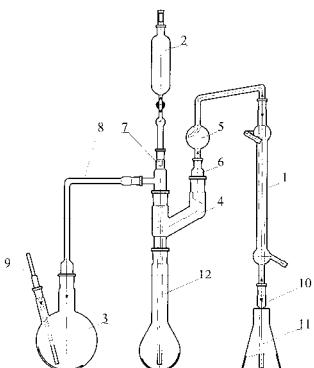
Состоит из холодильника ХПТ-1-300-14/23 поз.1, воронки капельной ВК-100 поз.2, колбы КГУ-2-1-1000-29/32 поз.3, насадки Н3-29/32 поз.4, каплеуловителя КО-14/23-100 поз.5, перехода П1-29/32-14/23 поз.6, насадки специальной поз.7, изгиба поз.8, трубы поз.9, трубы поз.10, колбы конической Кн-3-250-34 поз.11, колбы Кельдаля 1-250-29/32 поз.12. В качестве сменных частей поставляются колба Кельдаля 1-500-29/32 и колба коническая Кн-3-500-34.
