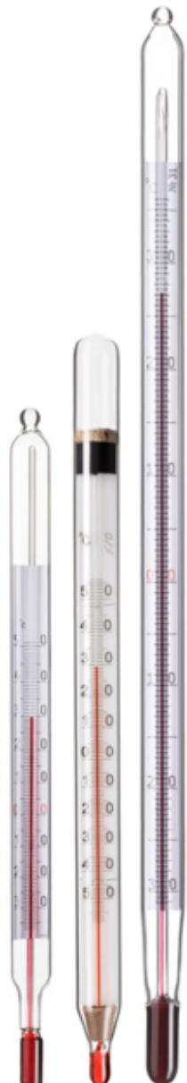
**Термометр вулканизаторный для измерения температуры при вулканизации резиновых изделий ТП-3**
