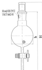
Пример обозначения: ВОРОНКА ДЕЛИТЕЛЬНАЯ ШАРООБРАЗНАЯ
